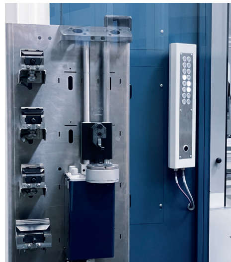
Integration mit SCHUNK NSR-A 160 in einer GROB Automation Integration with SCHUNK NSR-A 160 in a GROB automation
